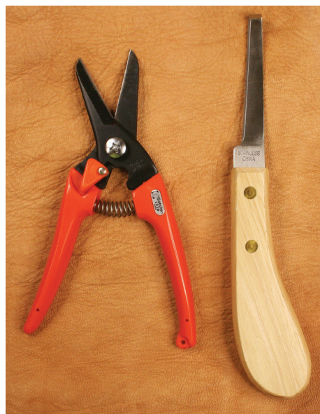
Herramientas de recorte de pezuñas. Tijeras a la izquierda y un cuchillo a la derecha.
