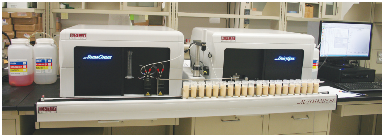
Una máquina de Bentley Instruments para realizar recuentos de células somáticas de leche y análisis de componentes.
