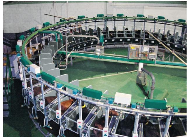
Figura 16. Diseño giratorio externo - 64 puestos - con indicador de rendimiento de leche.
