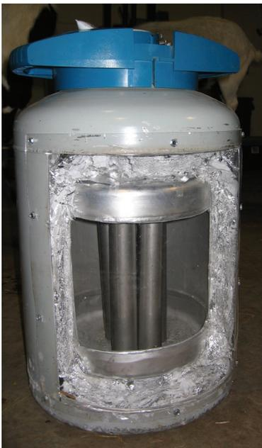
*Vista recortada de un tanque de almacenamiento de nitrógeno líquido que muestra el aislamiento y los cilindros.*
