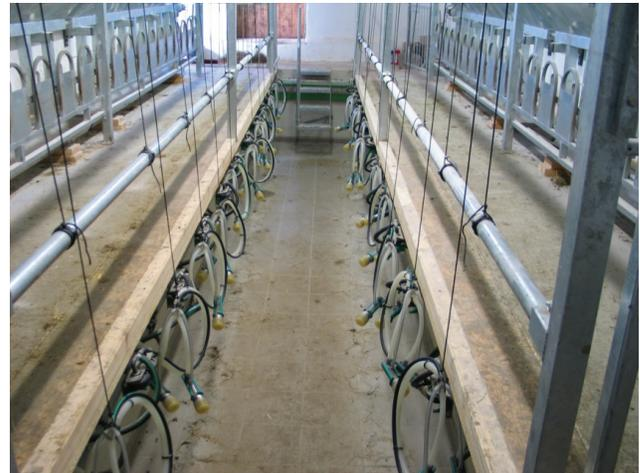
Figura 8. Sala en paralelo con un frente fijo - funcionamiento manual - sin automatización.
