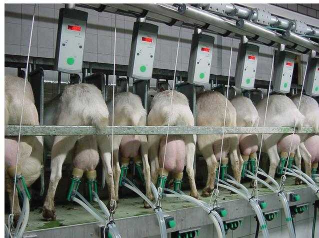
Figura 12. Alto nivel de automatización con dispositivos de medición de leche.
