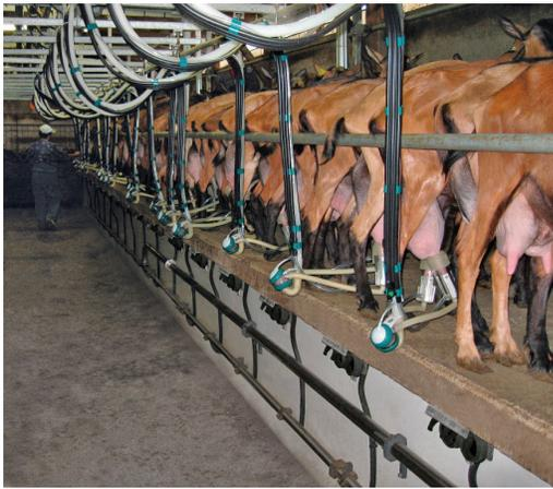
Figura 13. Muestra un sistema de oscilación - movimiento manual de la ordeñadora al otro lado de la fosa - retirado automático de la ordeñadora.
