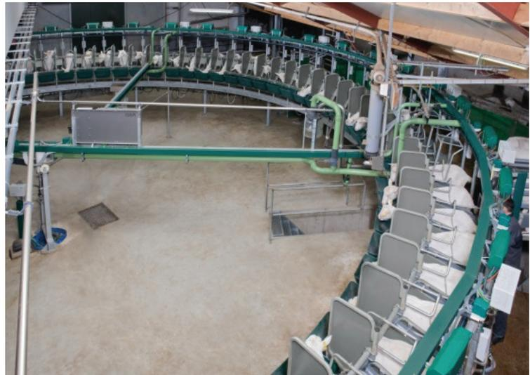
Figura 14. Plataforma giratoria externa con 72 puestos, alimentación y automatización completa; el control rotativo y el control de ordeño funcionan a la par. Un ordeñador puede operar el sistema ya que tiene un alto nivel de automatización. El tiempo de ciclo por puesto es de aproximadamente 4 segundos.
